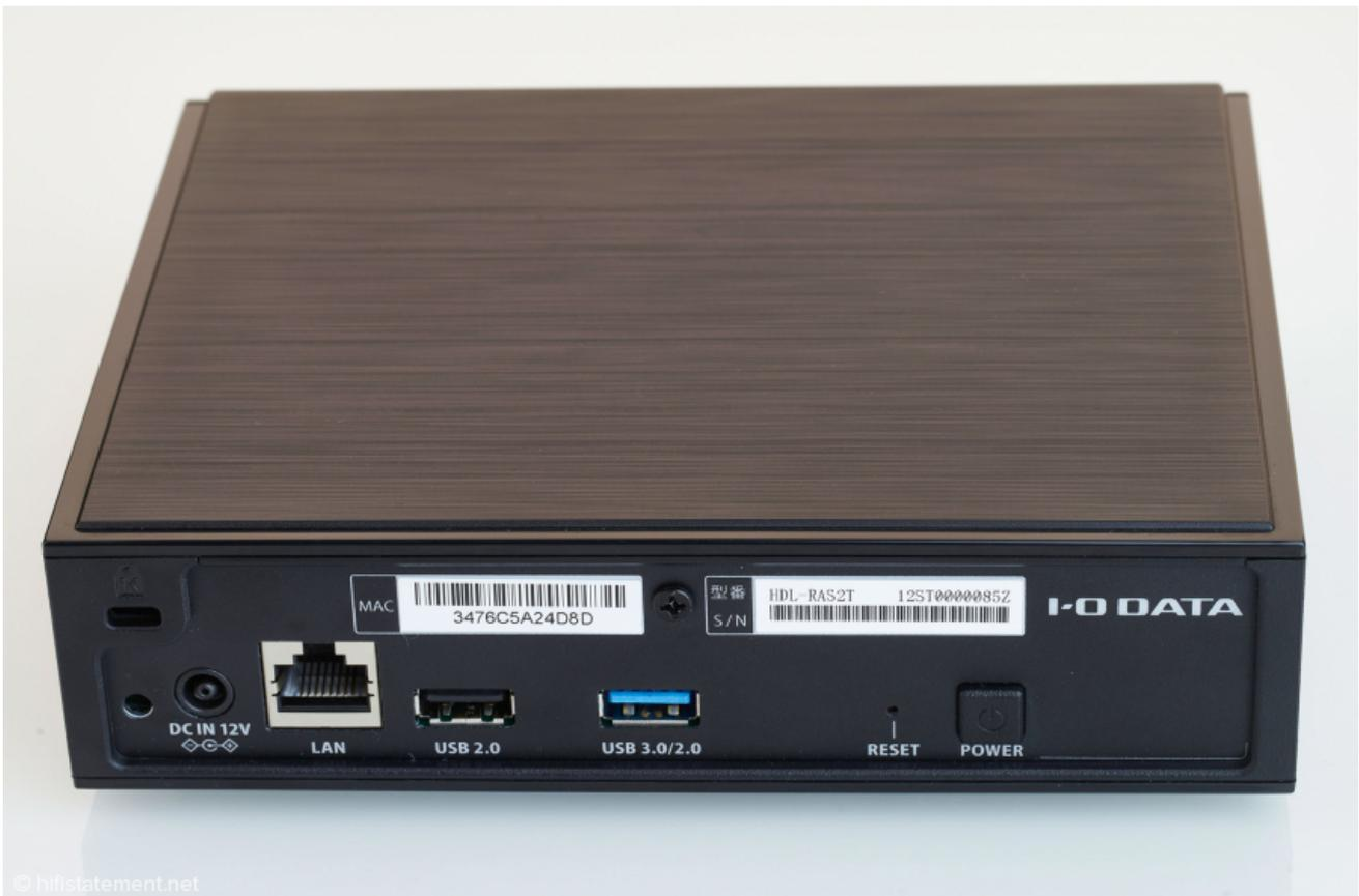
Beide USB-Ports ermöglichen den Anschluss des D/A-Wandlers. Üblich dafür ist die Verwendung des USB 2.0. Der 3.0 erlaubt dann schnelles Überspielen von oder zum I-O Data
